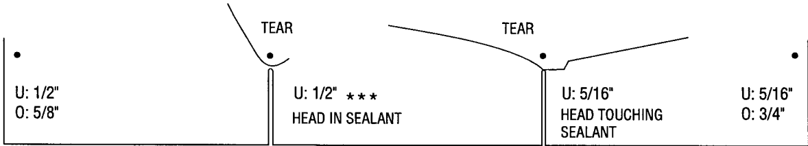
B1 E2 35° RUN 70 DAMAGE INDEX: 48
