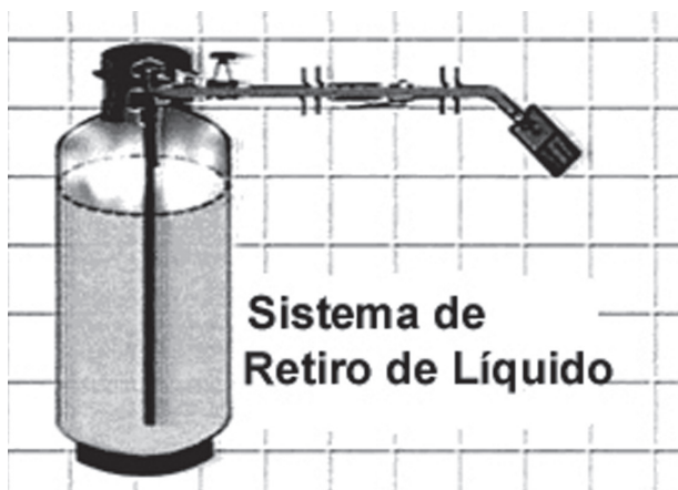
Figura 5: El combustible líquido es jalado desde el fondo del tanque.
