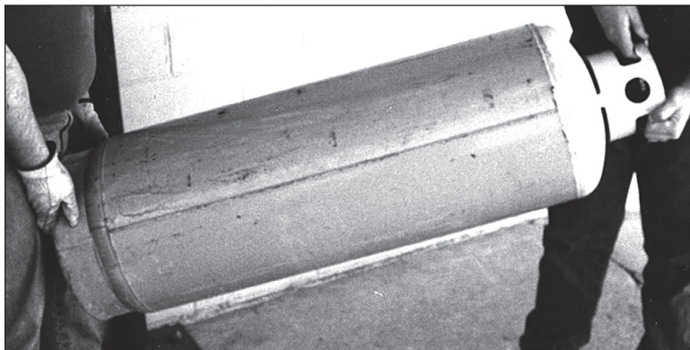
Foto 5: Muestra la forma correcta de transportar un cilindro de 100 libras.
