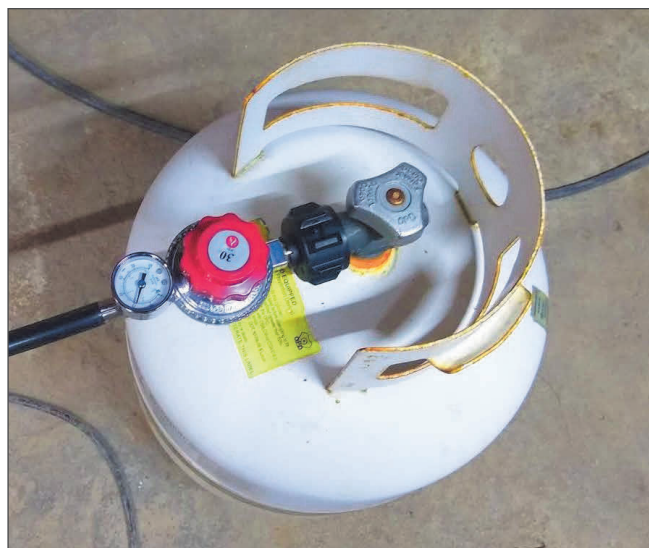
Foto 6: Conjunto regulador de presión ajustable
