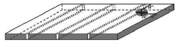
Haga un agujero a 18 pulgadas de un lado y a 18-24 pulgadas de un extremo en dos de las tres maquetas básicas de cubierta plana. Utilice un lata metálica para tartas de 9 pulgadas, una lata grande de café o un tapajuntas de cono alto de acero galvanizado invertido cortado a la altura necesaria para simular una abertura de desagüe del techo. Fije el desagüe de techo simulado en el orificio.
