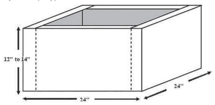
Construya una maqueta básica de la caja de tapajuntas utilizando cuatro piezas de madera dimensional de 2 por 12 ó 14 pulgadas clavadas con clavos de 16d. Añada nuevos listones de peralte en cada sesión de formación.
